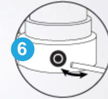
6 Inserte a presión el otro extremo de la manguera en la entrada de la base del purificador
