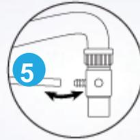
5 Coloque a presión un extremo de la manguera en el pico de la válvula
